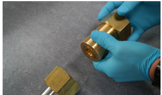
Bild 4. - Schrauben Sie die andere Seite ab
