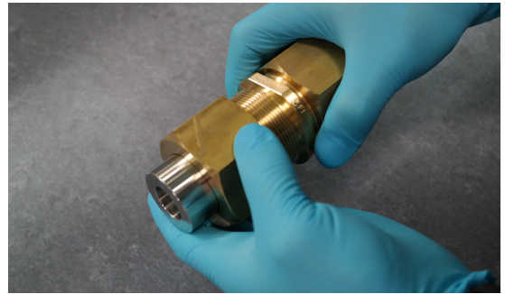
Bild 2. - Schrauben Sie die Überwurfmutter ab
